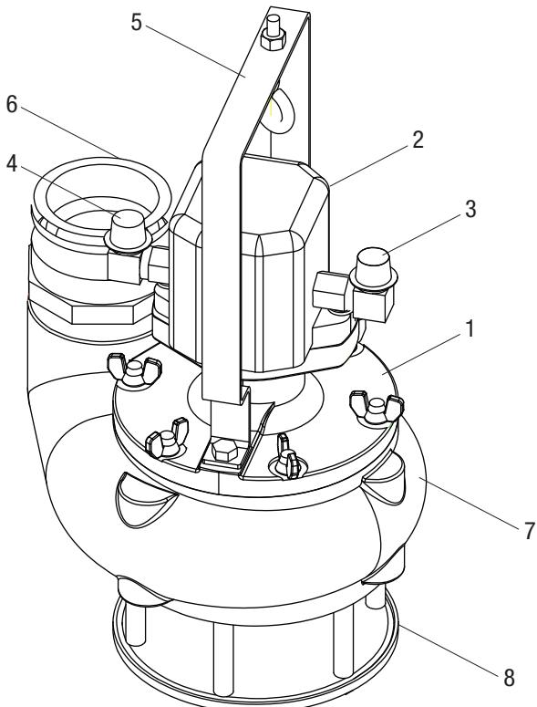
**Bomba sumergible para residuos y sedimentos H4635**
